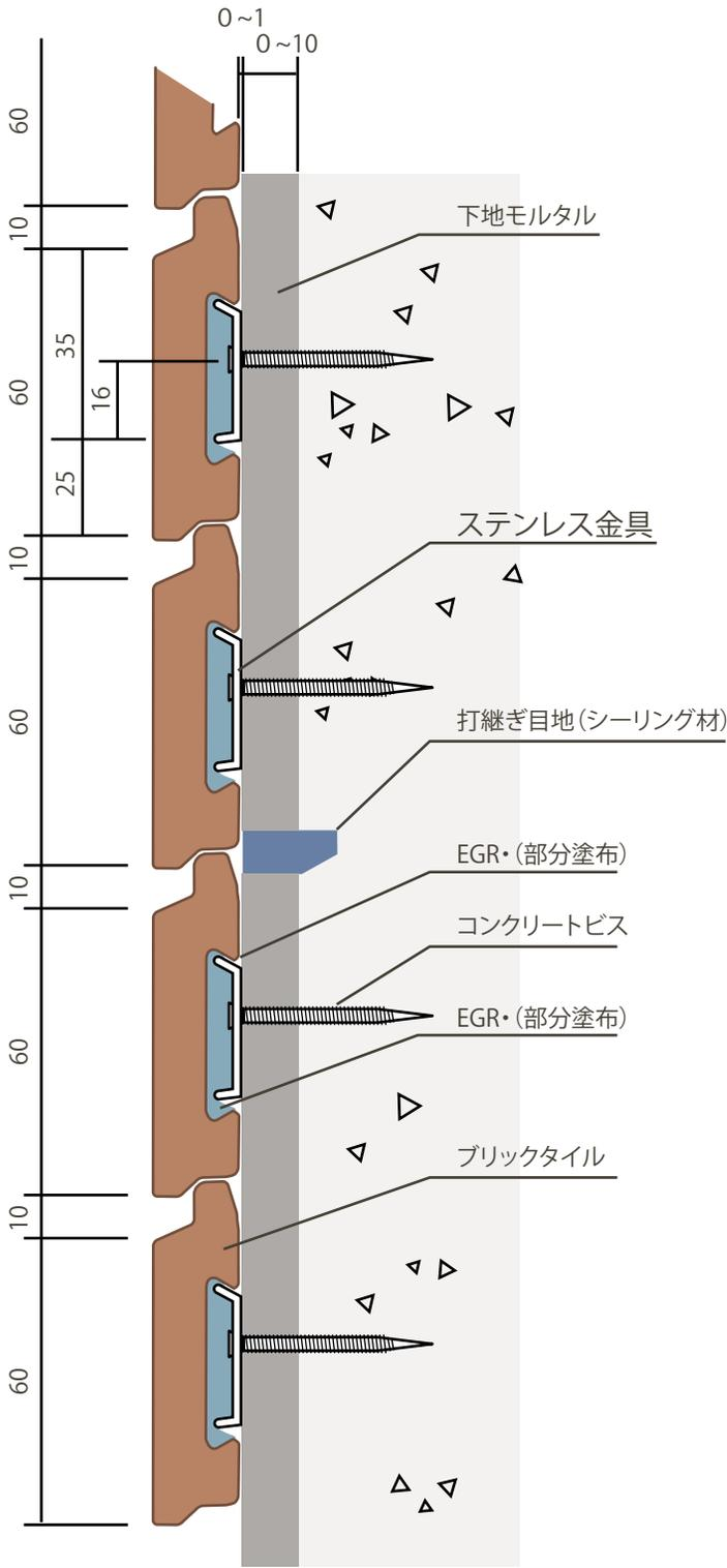
■ 有機系接着剤で接着固定した例の断面
