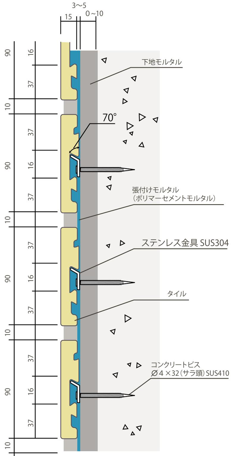
■ モルタルで接着固定した例の断面
